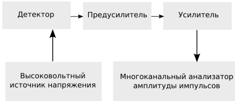
Рис. 2.1. Блок-схема гамма-спектрометрической системы на базе многоканального анализатора
